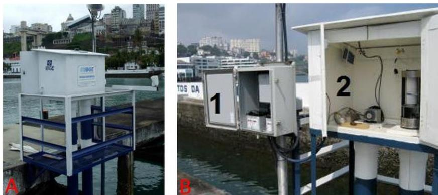
*Figura 5 – A) Estação Maregráfica situada na Capitania dos Portos, em Salvador; B) Instrumentos de medição do nível d’água da estação maregráfica de Salvador. (1) Datalogger. (2) Marégrafo digital com sistema encoder e radar acoplado.*
